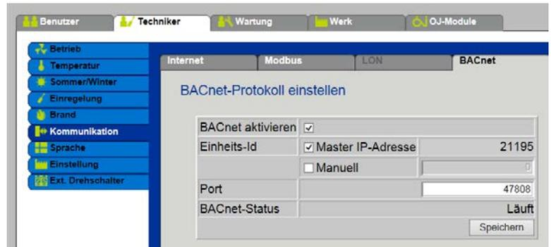
BACnet TCP/IP für externe Verbindung zu BMS-Anlage.
