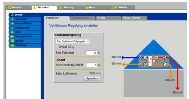
Wenn unter "OJ Module > Konfiguration > Einstellungen" "Modulierte Umluft" gewählt und unter "Werk > Konfiguration > Mechanisch" eine Umluftklappe konfiguriert wurde, kann hier die modulierte Umluft bezüglich des CO2-Setpunktes regeln.
