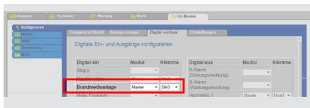
Wenn der Eingang "Brandmeldeanlage" auf "On" geschaltet ist, läuft die Anlage im Normalbetrieb.
