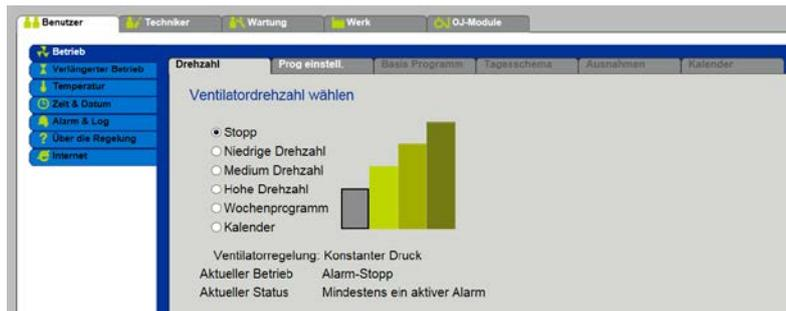
✚ *Wurde die Anlage gemäß Zeitprogramm gestoppt, kann die Anlage automatisch gemäß den Einstellungen für „minimale Nachttemperatur“ und „Sommernachtkühlung“ starten, und bei aktiviertem Digitaleingang für „Hohe Drehzahl“ ist die Anlage in die eingestellte Zeit in Betrieb.*
