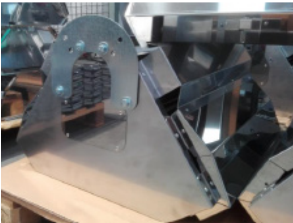
Bild 1 – Befestigung mit Ketten Typ Infra HT.2
